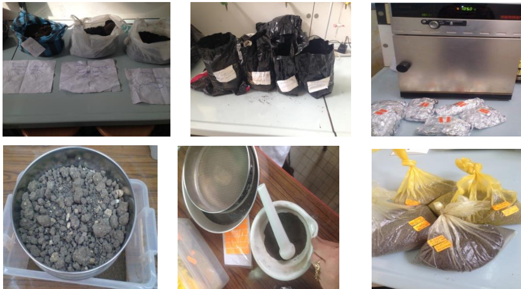
Photos 3: Etapes de séchage et tamisage des sols
